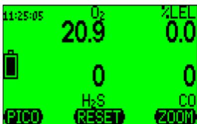
Si usted no se encuentra en una zona con aire fresco, o usted no desea utilizar el sensor zero, entonces presione el botón izquierdo (detect) después del periodo de seteo de encendido, para cambiar al modo detección. El G450 esta listo para operación si todos los valores de medición, la unidad y los gases son mostrados por pantalla.
