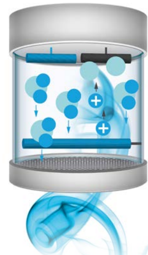
Electrochimique : solution de détection pour les gaz toxiques, O 2 et H 2
