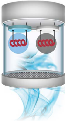
Combustion catalytique : solution de détection des gaz inflammables
