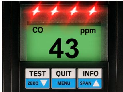
boutons de commande. En fonctionnement normal, l'afficheur indique la valeur mesurée ou des informations sur les défauts ou les alarmes. En outre, les paramètres de fonctionnement (gaz de mesure, plage de mesure, valeurs limites, etc.) peuvent être appelés par les boutons de commande.
