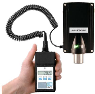
être équipés d'un câble installé de façon permanente. Cela permet de connecter la télécommande RC2 pour les travaux de maintenance et d'effectuer les réglages de manière pratique du niveau du sol. L'écran de la télécommande RC2 indique les mêmes informations que les versions EC28 avec afficheur. L'inspection, l'entretien et le calibrage sont ainsi substantiellement simplifiés.
